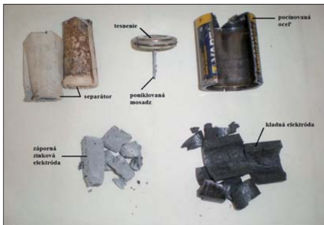
Obr.4: Alkalická batéria po ručnej demontáži
