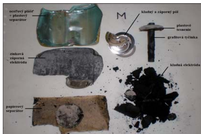
Obr. 2: Zn–C batéria po ručnej demontáži
