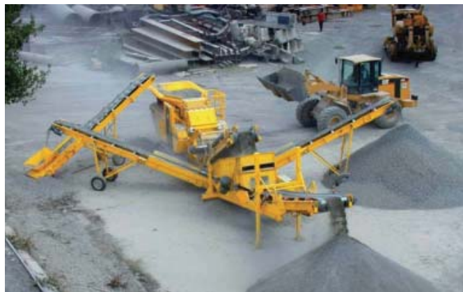
Obr. 2: Mobilný odrazový drvič o výkone 120 t/hod
