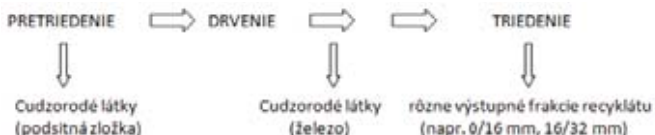
Obr. 1: Schéma postupu recyklácie stavebného odpadu
